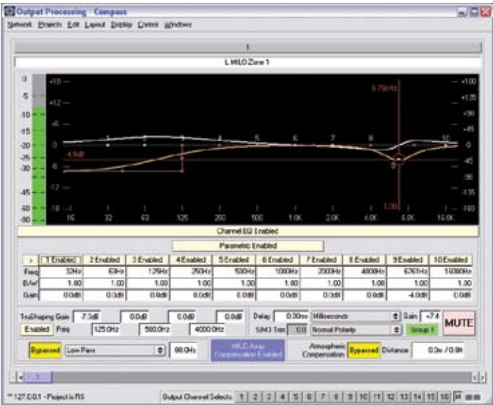
Galileo 616提供强大的信号处理库，加入延迟和多种形式的滤波。上图所示为配置Galileo 616 Composite EQ的Compass屏幕，在每个输入和输出上均提供。
